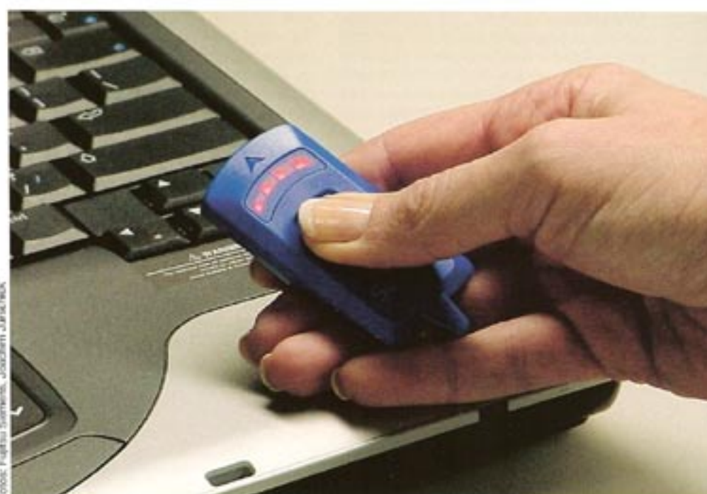
Auf der Hotspot-Suche ist der „WiFi-Seeker“ (39 Euro, www.wifiseeker.de ) ein hilfreiches Werkzeug. Er zeigt mit 4 LEDs die Funkfeldstärke an, differenziert indes nicht zwischen öffentlichen und verschlüsselten Netzwerken.
